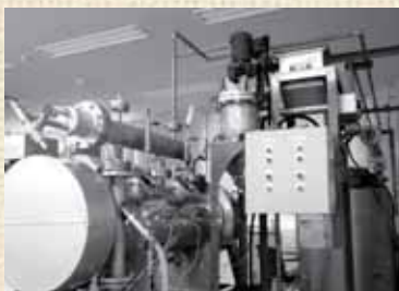
連続処理が可能な化学品の製造装置「完全フロー型マイクロ波リアクター」
